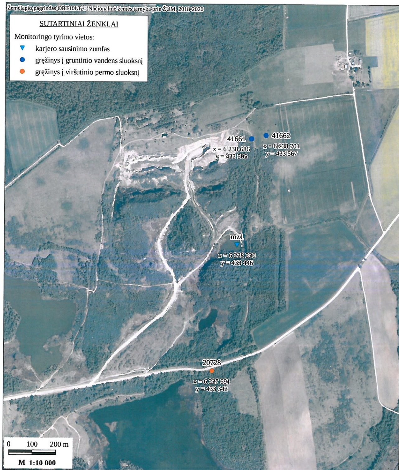
Menčių karjero monitoringo tinklo schema
